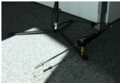
Abb. 8: Erste Messung der Zugluft auf 0,1 m Höhe am Boden.
