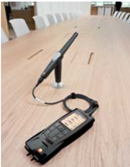
Abb. 13: Raumluftqualität messen mit testo 480.
