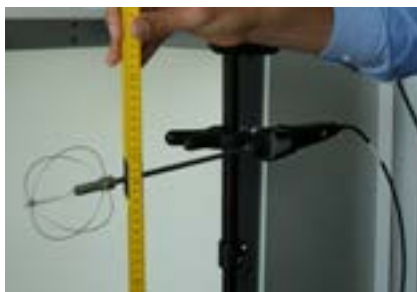
Abb. 9: Zweite Messung der Zugluft auf Tischhöhe (0,6 m).
