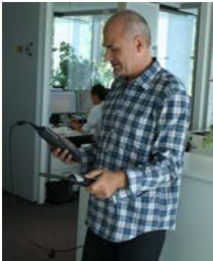
Abb. 3: Messen der Raumlufttemperatur und Raumluftfeuchte mit dem Klima-Messgerät testo 480.
