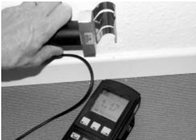
Abb. 10: Handhaltung einer Schleifenkopfsonde
