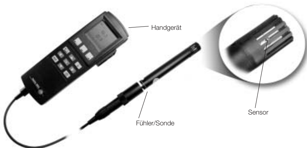
Abb. 1: Bestandteile eines Messgeräts
