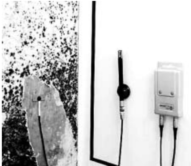
Abb. 30: Befestigung eines Plättchenfühlers
