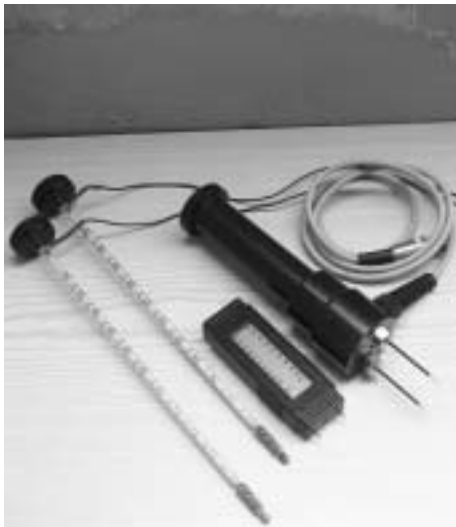
Abb. 12: Sondentypen für Leitfähigkeitsmessung
